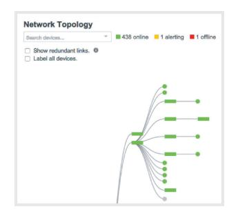
在拓扑视图中,正方形代表 MX 安全设备,矩形代表 MS 交换机,而圆圈代表 MR 无线接入点。 Meraki 拓扑还能检测到距离为一跳的非 Meraki 设备(以空菱形显示)。根据非 Meraki 设备支持的协议,拓扑视图可能还能够识别发现协议数据(例如型号类型、IP 和制造商)。例如,思科交换机和路由器还将包括基于思科发现协议 (CDP) 和链路层发现协议 (LLDP) 的广泛信息。
